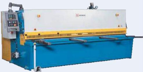
Stabile Schwingschnittkonstruktion mit Blechhochhaltevorrichtung und NC-Steuerung für den Hinteranschlag
