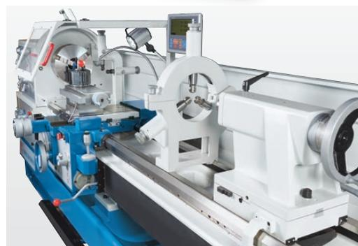
Lünetten zur präzisen Bearbeitung langer Werkstücke
