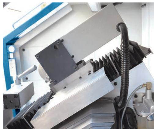
Schrägbettbauweise für optimierten Arbeitsraum und Späneabfuhr
