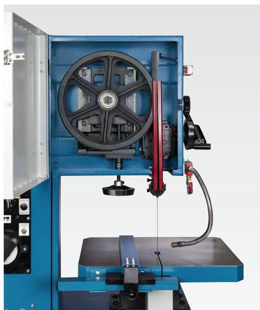
Die besonders stabile Führung des Umlenkrades garantiert dessen dauerhaft präzise Ausrichtung und steigert damit die Schneidleistung und Standzeit der Bandsägeblätter
