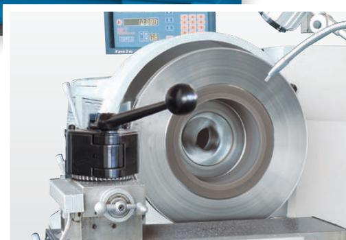
Konstante Schnittgeschwindigkeit für eine perfekte Oberfläche
