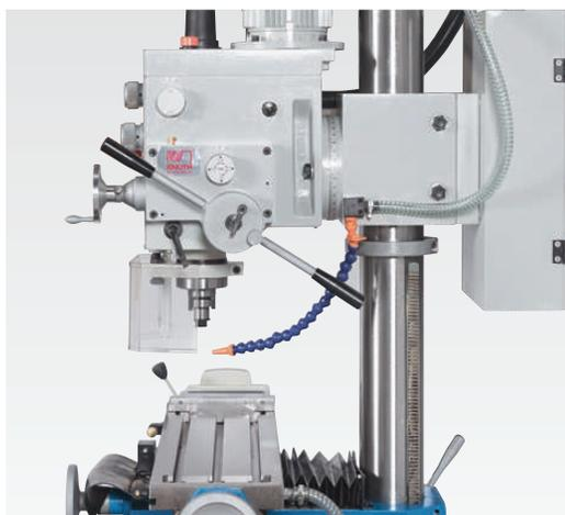
Automatischer Pinolenvorschub mit 3-Stufengetriebe
